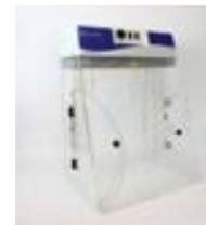
Limite les contaminations de la réaction PCR. La cabine PCR Fisherbrand™ avec minuterie offre une zone pratique pour configurer les réactions PCR dans un environnement sans acide nucléique.
