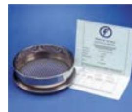
Fabriqués en acier inox et disponibles dans une grande variété de tailles. Le tamis de test en acier inox avec maille en fil tissé Fisherbrand™ mesure 200 mm de diamètre.
