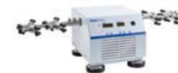
Conçu pour simuler le mouvement de va-et-vient du poignet humain
