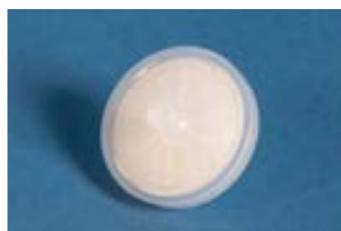
Conçu pour la filtration et la purification en milieu stérile. Le filtre à seringue en PES stérile Fisherbrand™ est doté d'une membrane en PES dans un boîtier en polypropylène pour la purification de solutions de culture tissulaire à partir d'une seringue standard. Membranes d'un diamètre de 33 mm disponibles avec des seuils de filtration de 0,2 ou de 0,45 µm.
