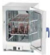
Plage de températures : Température ambiante + +7°C jusqu'à 75°C
