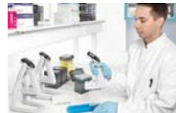
Grâce à l'espace inter-pointes réglable, transférez rapidement et efficacement les échantillons entre les tubes, racks, microplaques et boîtes de gel horizontales.
