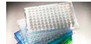
Les plaques de PCR à 96 puits Thermo Scientific™ Armadillo™ transparentes à demi-jupe sont les plus performantes des plaques de PCR en plastique.
